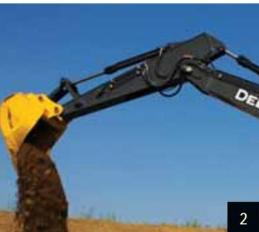
2. L'enduit au carbure de tungstène crée une surface extrêmement résistante à l'usure pour protéger le joint crucial du godet et du balancier.
