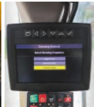
▲ Les paramètres relatifs au mode de fonctionnement et aux intervalles de graissage sont clairement affichés sur l'écran de la cabine. Un indicateur vous permet de surveiller l'interactivité du système.
