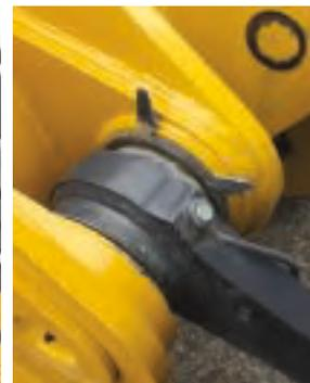
▲ Contrairement à plusieurs systèmes de recharge, qui comprennent des raccords de tuyaux complexes, l'option de lubrification automatique de John Deere comprend des conduites montées et des acheminements intégrés à la structure de la machine.
