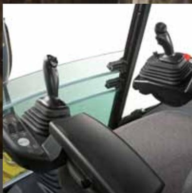
Les manettes confortables assurent une maîtrise douce et intuitive du balancier extensible, des outils auxiliaires de la chargeuse ou de la rétrocaveuse, du marteau, du P.A.M. et du klaxon.
