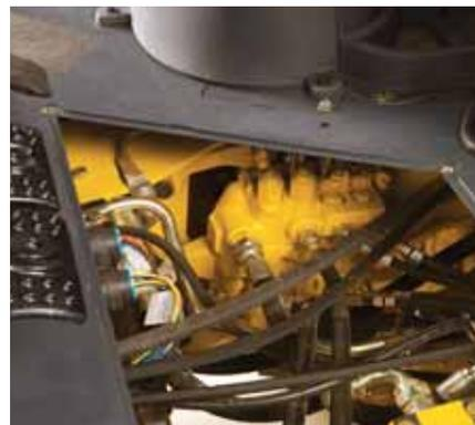
Les tapis sectionnés de plancher et le grand panneau amovible permettent d'accéder facilement, par le dessus, aux composants internes.
