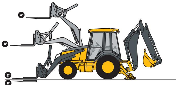
Capacités de levage en bout exprimées en lb (kg), selon la norme SAE J31. Les données fournies ici représentent 87 % de la capacité de levage maximale. La machine de base est équipée d'un contrepoids.
