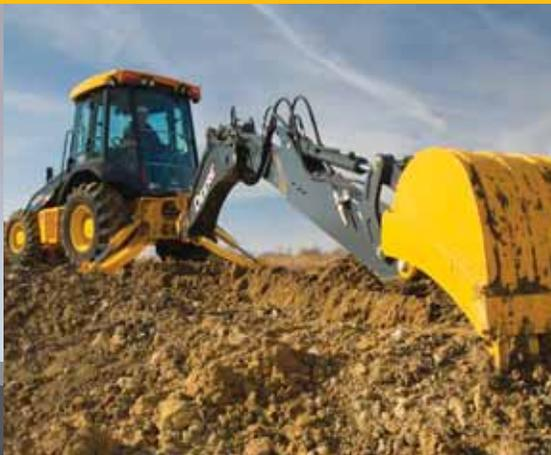
Le balancier extensible accroît la profondeur de creusage, la portée et la capacité. Le caisson extérieur agrippe les objets comme les dalles de béton entre le godet et les dents du bord d'attaque pendant l'extension ou la rentrée pour un chargement plus facile des camions.
