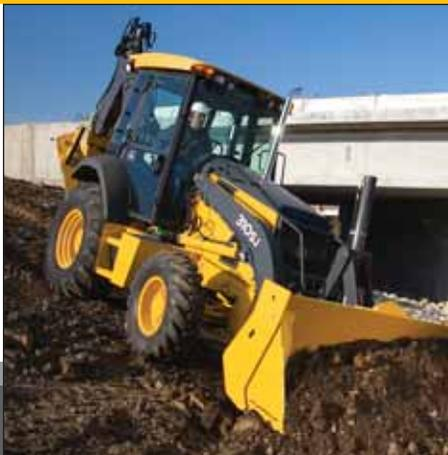
Le pont avant mécanique optionnel à glissement limité distribue aux roues avant 80 % de la puissance disponible pour optimiser l'adhérence. Il peut être engagé en marche pour une véritable traction intégrale sur demande.
