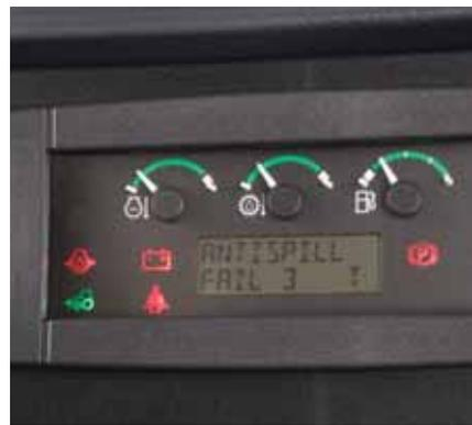
En cas d'anomalie de fonctionnement, le moniteur évolué fournit des messages diagnostiques faciles à comprendre pour vous permettre de reprendre le travail au plus tôt.
