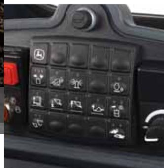
Les boutons-poussoirs rétroéclairés permettent de commander facilement la hauteur maximale de la flèche, le retour en position de creusage et le retour en position de transport.
