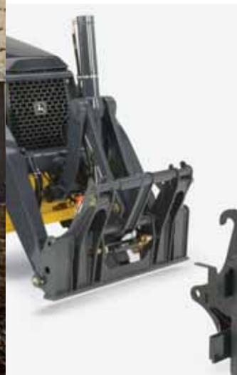
Le coupleur rapide Worksite Pro permet d'interchanger rapidement les instruments sans descendre de la machine. Il accepte une grande variété d'outils.
