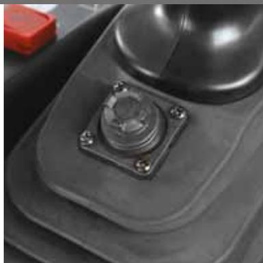
Vous devez déplacer rapidement ou libérer la machine ? Les petites manettes permettent d'utiliser simultanément la chargeuse et la rétrocaveuse sans relâcher les leviers principaux ou sans faire pivoter le siège.
