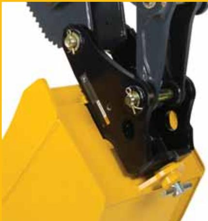
Le coupleur Worksite Pro™ à crochet supérieur permet d'interchanger rapidement et facilement les godets à simple goupille. Pour godets de 12, 18 et 24 po (30, 45 et 60 cm) pour service dur.
