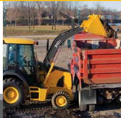
La flèche incurvée de la chargeuse améliore la visibilité et la portée, et facilite le déversement au centre du camion pour un chargement plus complet et plus rapide.
