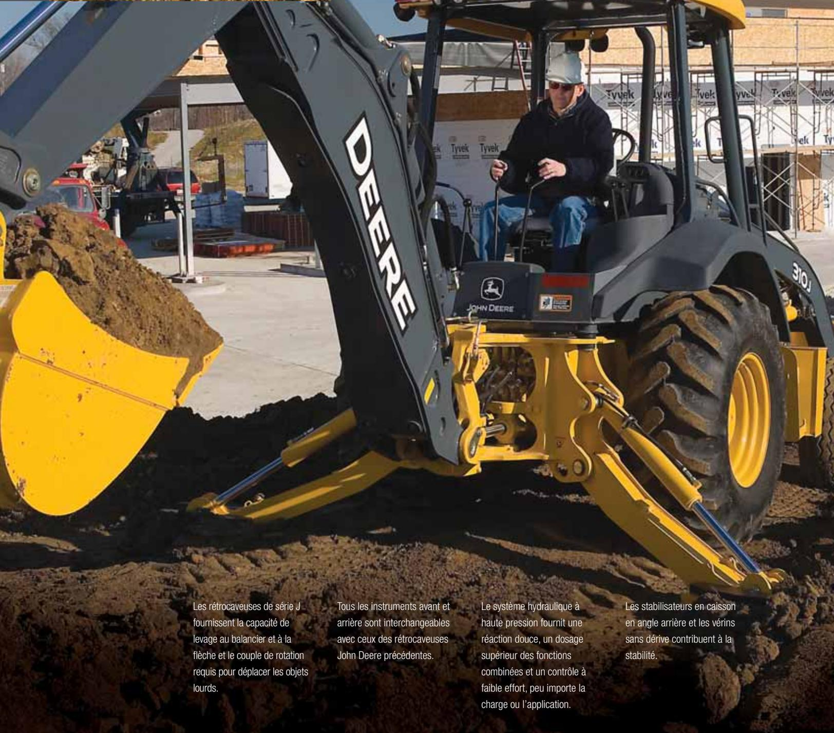
Les rétrocaveuses de série J fournissent la capacité de levage au balancier et à la flèche et le couple de rotation requis pour déplacer les objets lourds.
