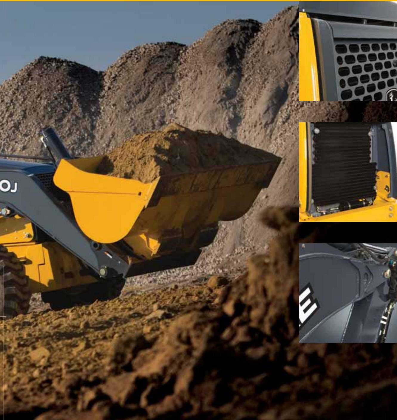
Le capot du moteur est fabriqué de matière composite résiliente qui résiste aux chocs et à l'endommagement. Les rallonges standard de la grille protègent encore mieux la section frontale.
