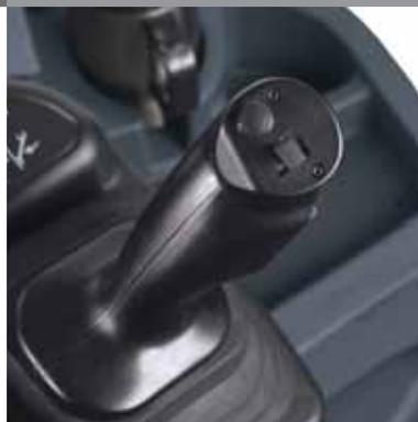
Le commutateur de la manette actionne les outils hydrauliques. Il bascule en/hors fonction ou peut être enfoncé et maintenu pour un contrôle momentané. Les interrupteurs intégrés à l'accoudoir activent les stabilisateurs.
