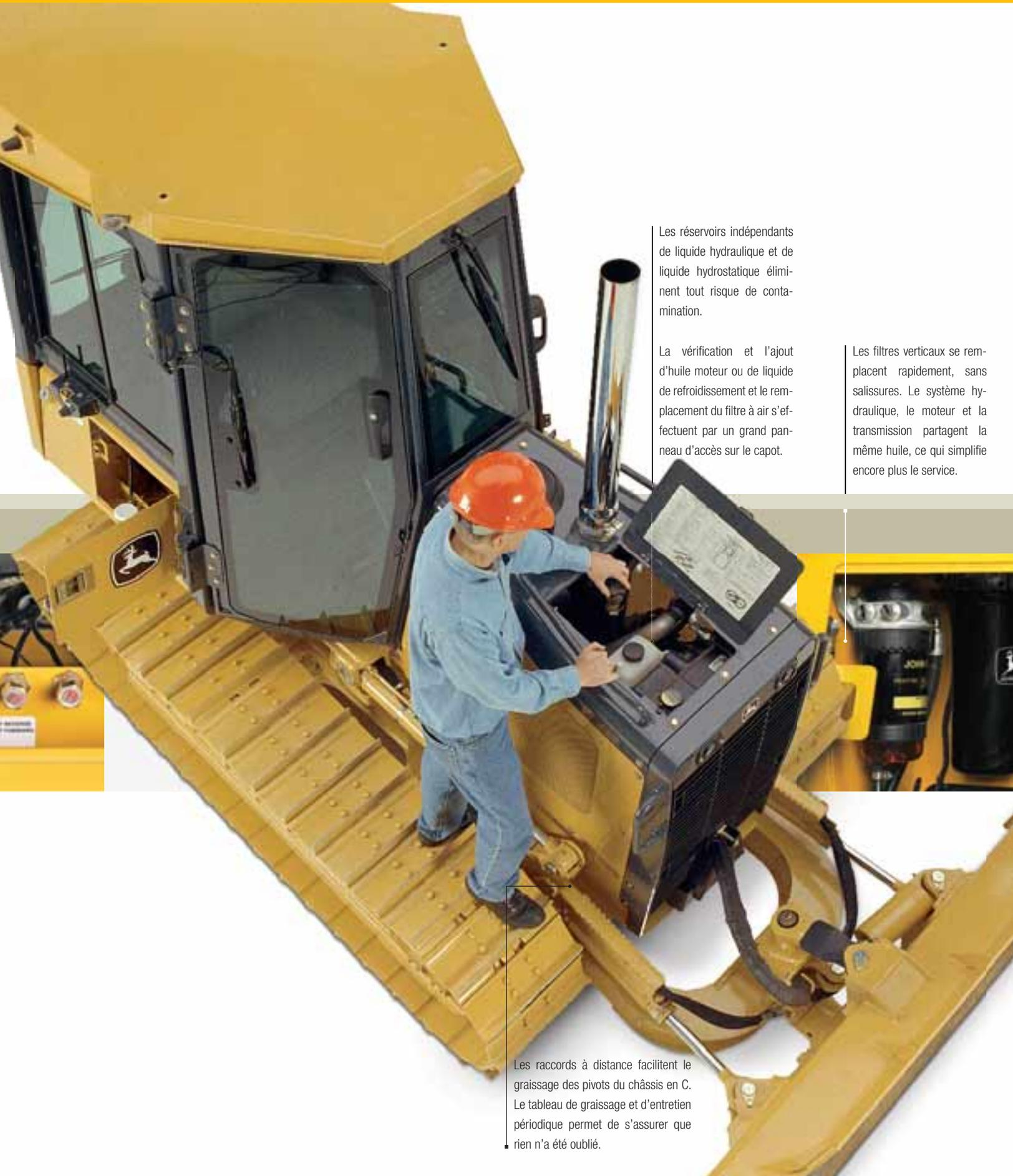
Les réservoirs indépendants de liquide hydraulique et de liquide hydrostatatique éliminent tout risque de contamination.
