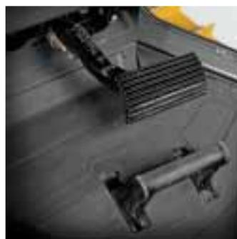
Choisissez la fonction de décélérateur qui convient au travail. Ralentissez la vitesse de marche et le régime moteur, ou uniquement la vitesse de marche pour maintenir l'adhérence sans perte de puissance motrice ni de réaction hydraulique. Le serrage des freins s'effectue en enfonçant complètement la pédale.
