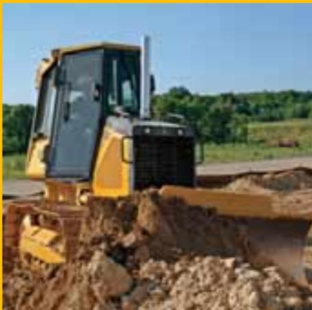
Gage de productivité, la différenciation de vitesse des chenilles permet à l'opérateur de neutraliser les lourdes charges en coin et de repositionner rapidement la lame, en marche. Permet aussi de pivoter sur place.
