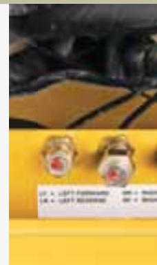
Les prises d'essai et l'affichage de message diagnostique permettent aux techniciens d'effectuer un dépannage rapide.
