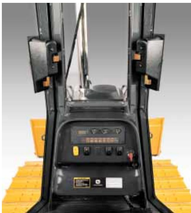
Grâce à la construction à cabine avancée, l'opérateur est en position plus stable et a une meilleure vue de l'arrière et du dessous de la lame et du terrain. Le contrôleur effectue la surveillance vigilante des fonctions vitales de la machine et déclenche au besoin une alarme visuelle et sonore.
