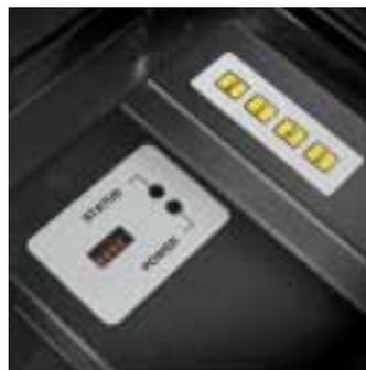
Seul le contrôleur de transmission de John Deere permet de régler finement la réaction ainsi que le mode du décélérateur, les gammes de marche avant/arrière, la modulation de la direction et les rapports de vitesse avant/arrière.
