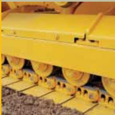
Les tôles inclinées pleine longueur des bâtis de chenilles et les supports de rouleau incurvés résistent à l'accumulation de débris et simplifient le nettoyage.
