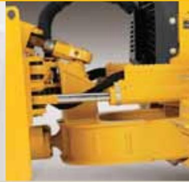
Robuste châssis en C à construction en caisson et soudure automatique et lame du type à alvéoles fermés. Robuste joint d'articulation à rotule résistant à l'accumulation des débris pour assurer la précision du travail à long terme.
