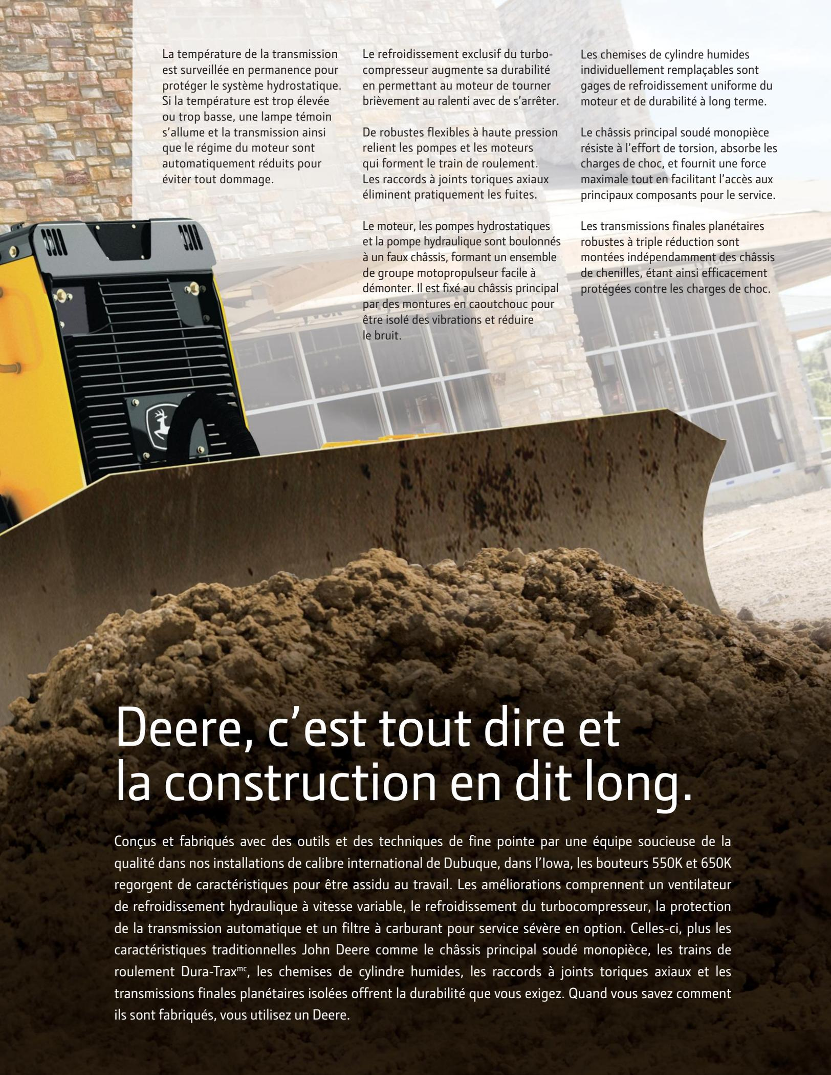
La température de la transmission est surveillée en permanence pour protéger le système hydrostatique. Si la température est trop élevée ou trop basse, une lampe témoin s'allume et la transmission ainsi que le régime du moteur sont automatiquement réduits pour éviter tout dommage.
