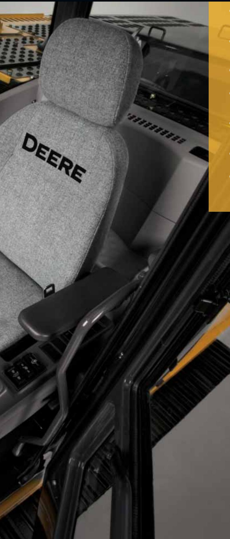
Le siège à suspension pneumatique de luxe à multiples positions se règle sur 26 cm, coulissant avec la console ou indépendamment.
