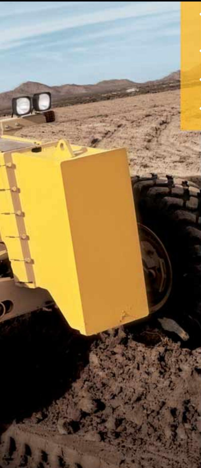
Les six roues motrices font travailler tout le poids de la machine, ce qui rend les niveleuses 672D, 772D et 872D plus productives pour tous genres d'applications, même le nivellement fin.
