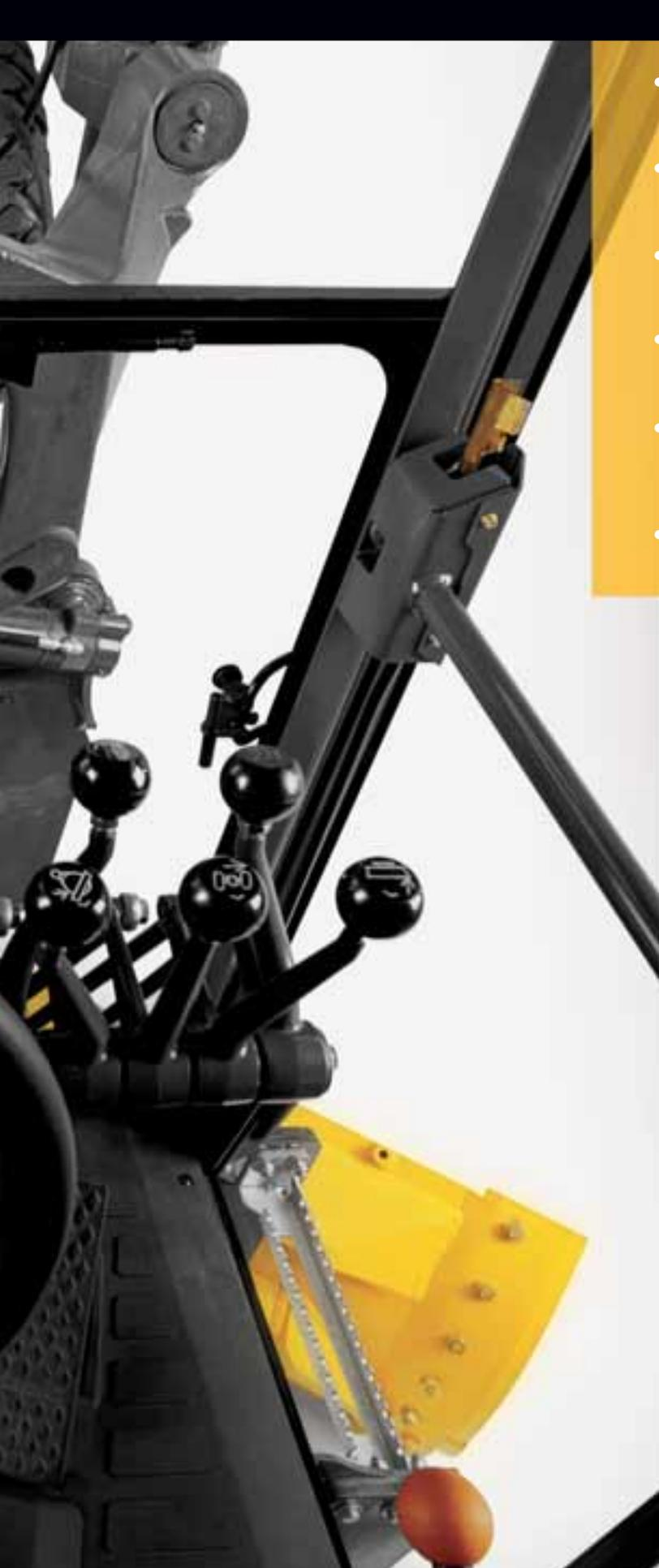
Les vitres teintées pleine hauteur procurent une vue dégagée de l'avant et de l'arrière de la lame, de l'arrière du bord de coupe et des pneus avant.
