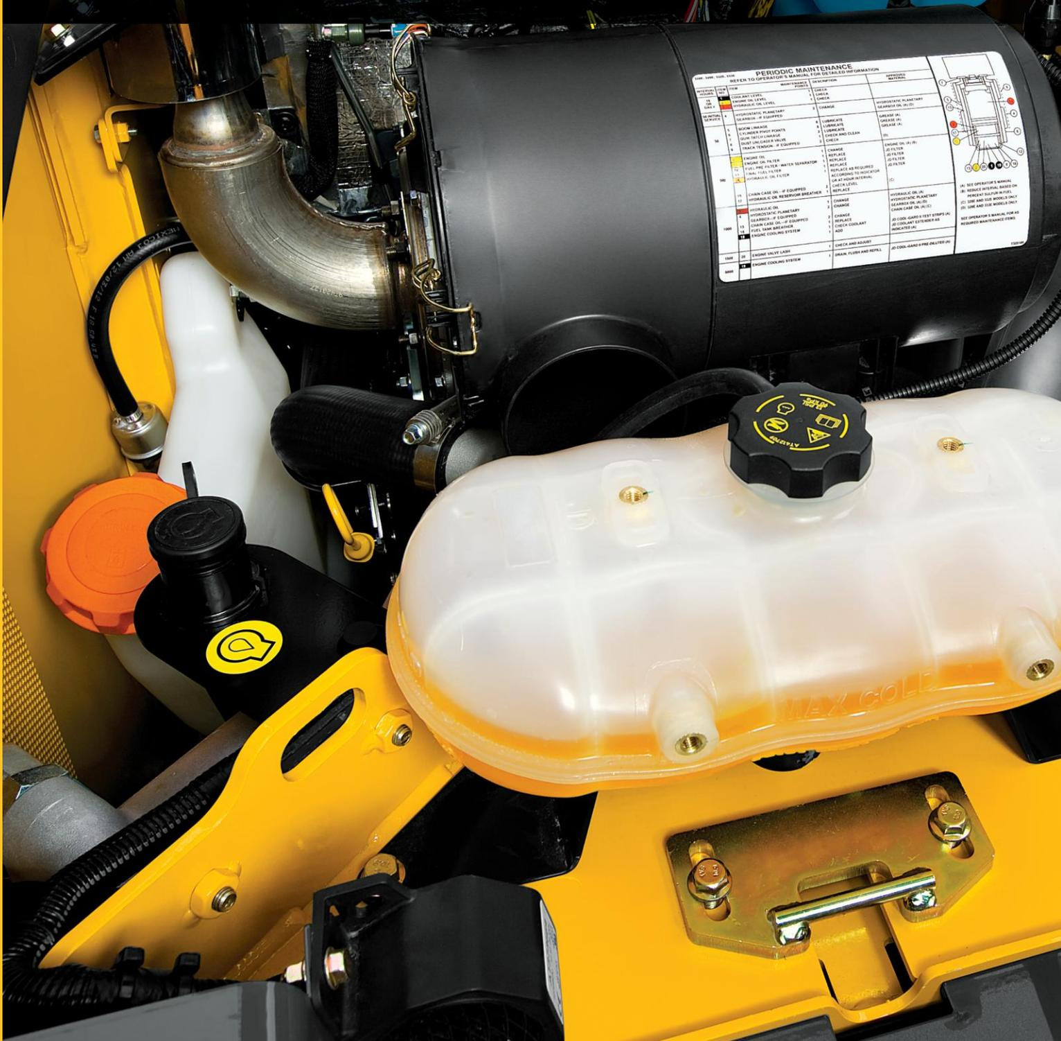
L'entretien quotidien est rapide et facile. Il suffit de soulever le capot assisté d'un cylindre à gaz pour accéder aux points de vérification et de réapprovisionnement.
