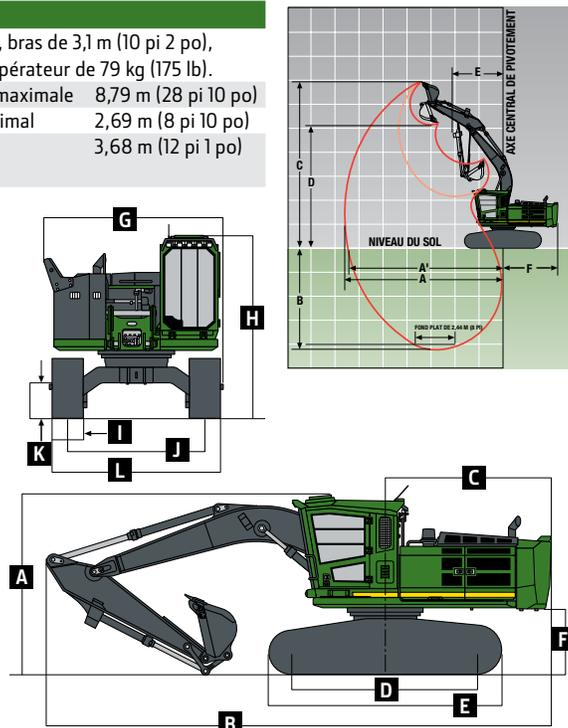
Le poids de l'accessoire n'est pas inclus dans le calcul des capacités de levage. Les chiffres en caractères gras expriment les capacités limitées par le système hydraulique avec augmentation de puissance; les chiffres en caractères usuels expriment les capacités limitées par la stabilité de la machine, en kg (lb). Les nombres ne dépassent pas 87 % des capacités hydrauliques ou 75 % du poids nécessaire pour faire basculer la machine.
