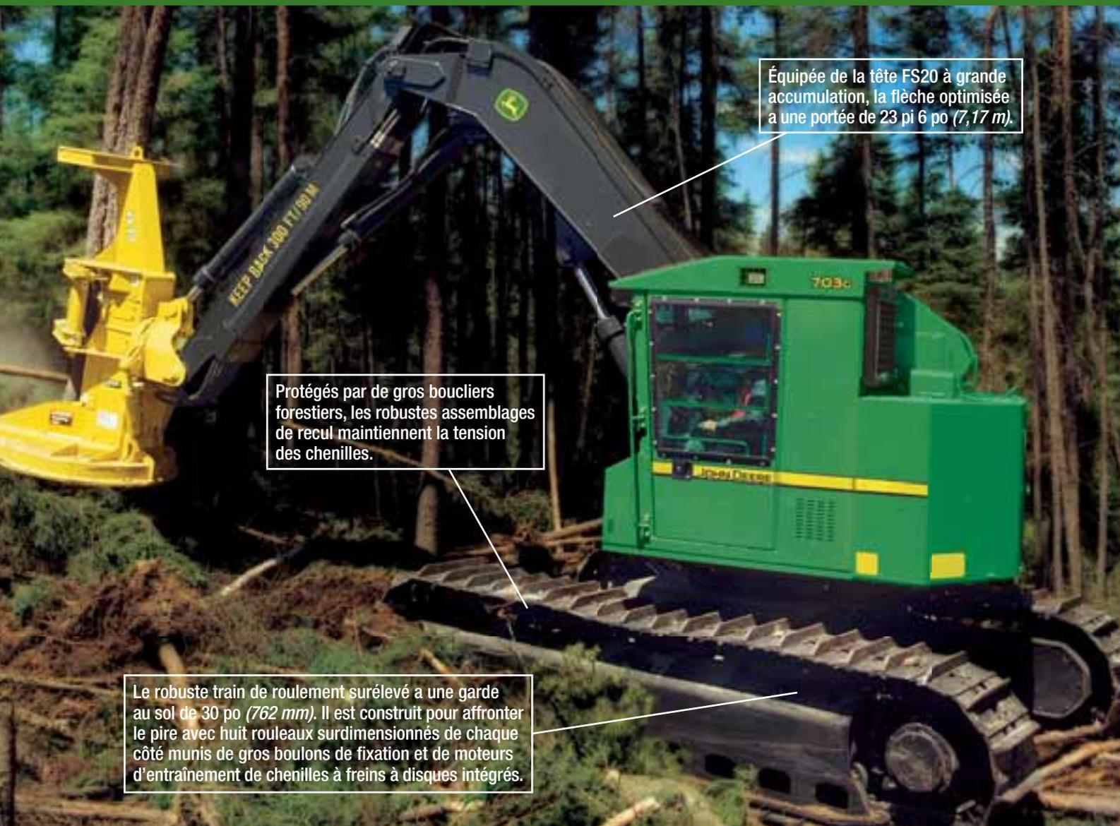
Équipée de la tête FS20 à grande accumulation, la flèche optimisée a une portée de 23 pi 6 po (7,17 m).
