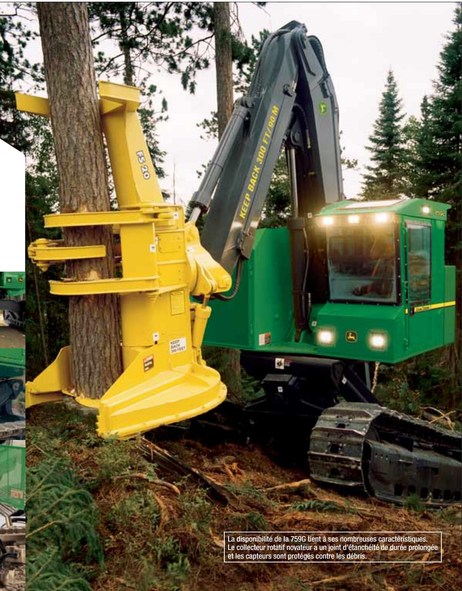
La disponibilité de la 759G tient à ses nombreuses caractéristiques. Le collecteur rotatif novateur a un joint d'étanchéité de durée prolongée et les capteurs sont protégés contre les débris.
