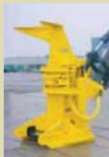
La FS20 est imbattable pour la haute accumulation. Le bras accumulateur simple et le bras d'abattage à deux dents assemblent rapidement de gros paquets dans l'accumulateur latéral. La grande ouverture de la FS20 permet un positionnement rapide et précis, sans l'interférence d'un évacuateur latéral. Cette construction laisse une vue dégagée de la zone de coupe jusqu'au sol, et l'opérateur conserve une vision dégagée jusqu'au dernier arbre du cycle.
