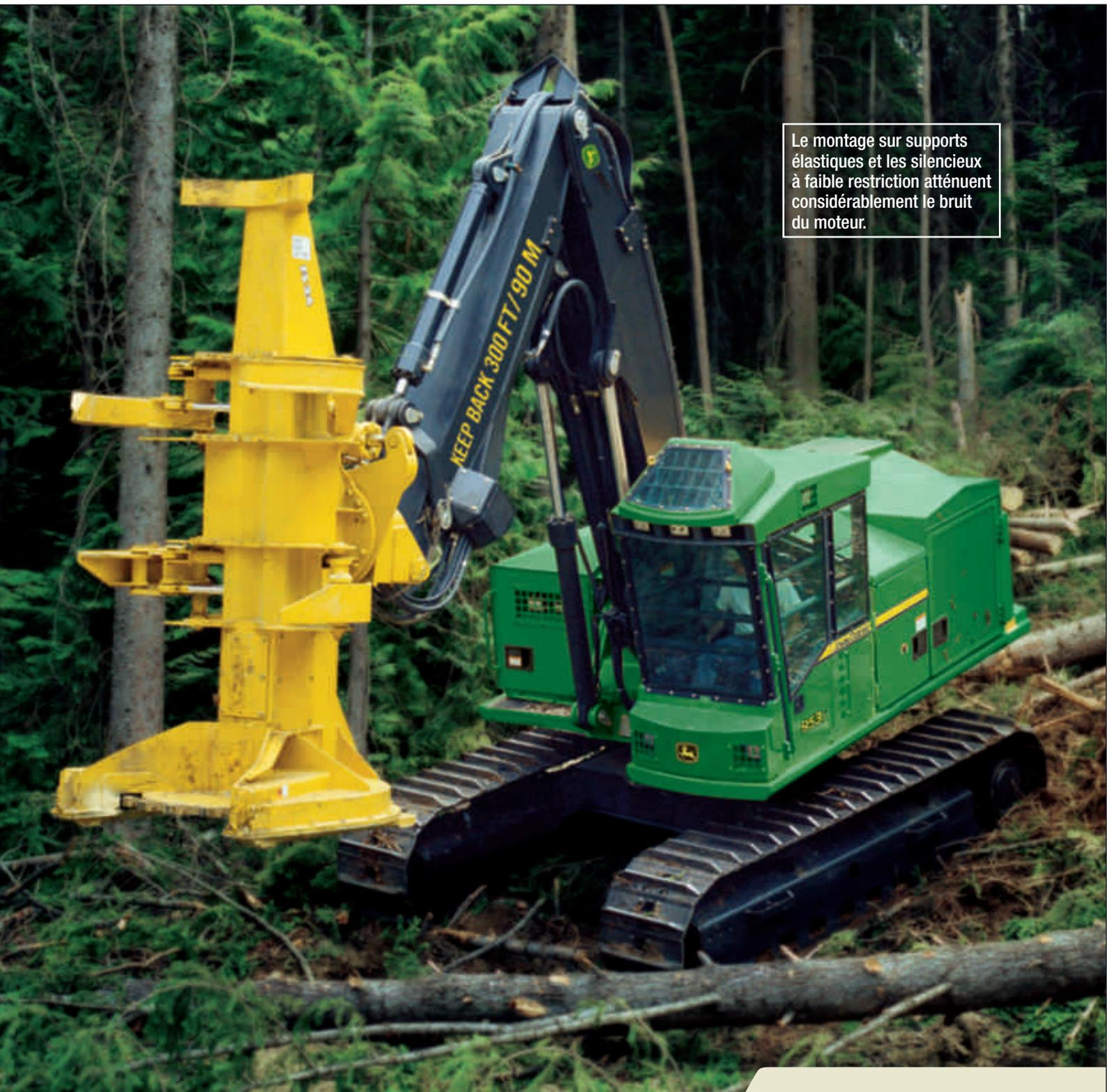
Le montage sur supports élastiques et les silencieux à faible restriction atténuent considérablement le bruit du moteur.
