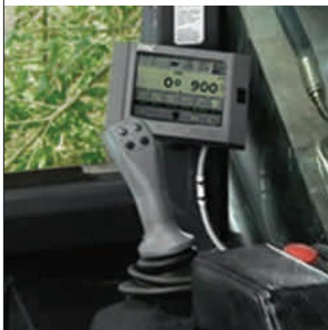
Le système TMC permet à l'opérateur de contrôler les fonctions du système hydraulique, du moteur, du déplacement, de la rotation et de la flèche. Les réglages de vitesse et de sensibilité peuvent être programmés pour sept opérateurs.
