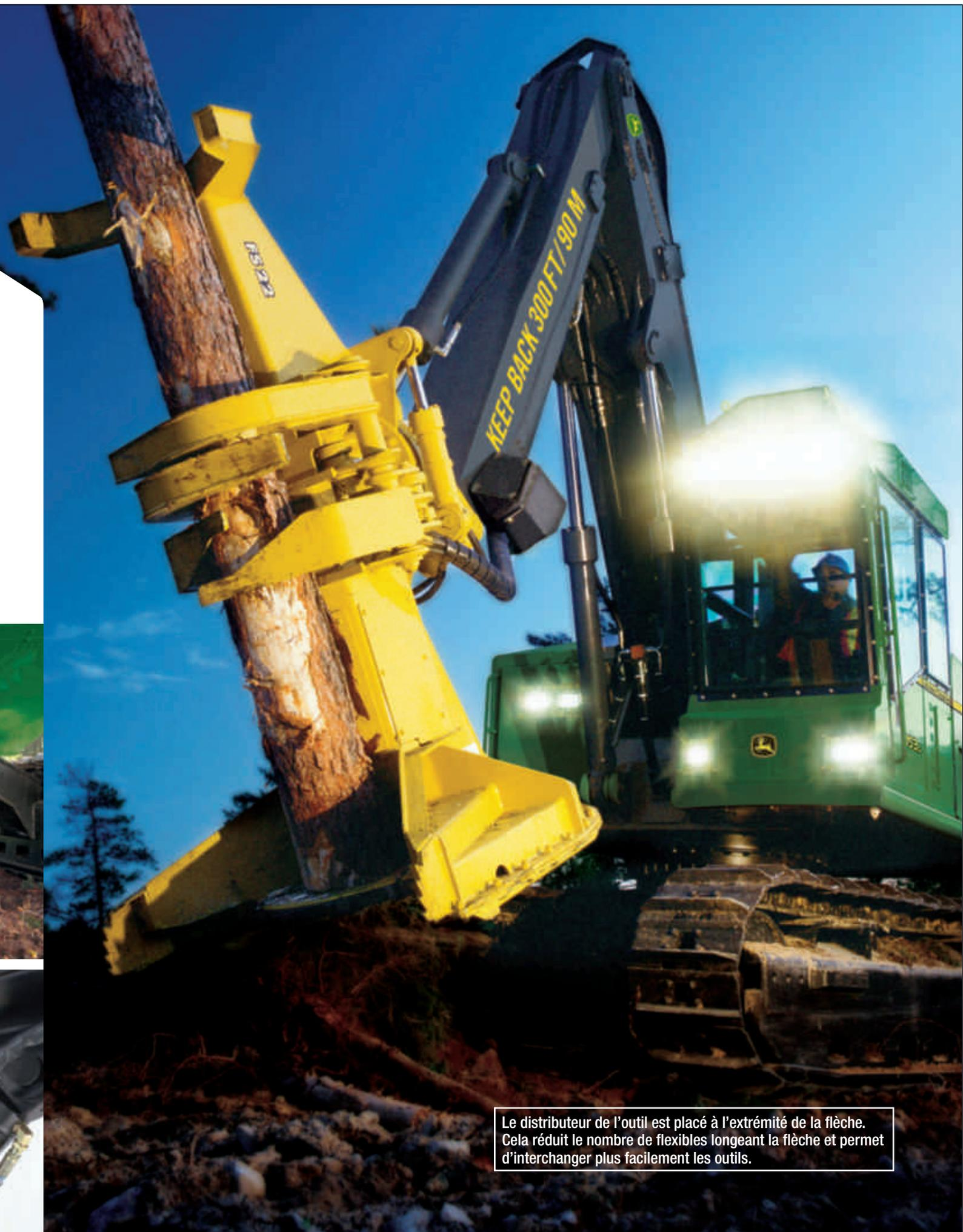
Le distributeur de l'outil est placé à l'extrémité de la flèche. Cela réduit le nombre de flexibles longeant la flèche et permet d'interchanger plus facilement les outils.
