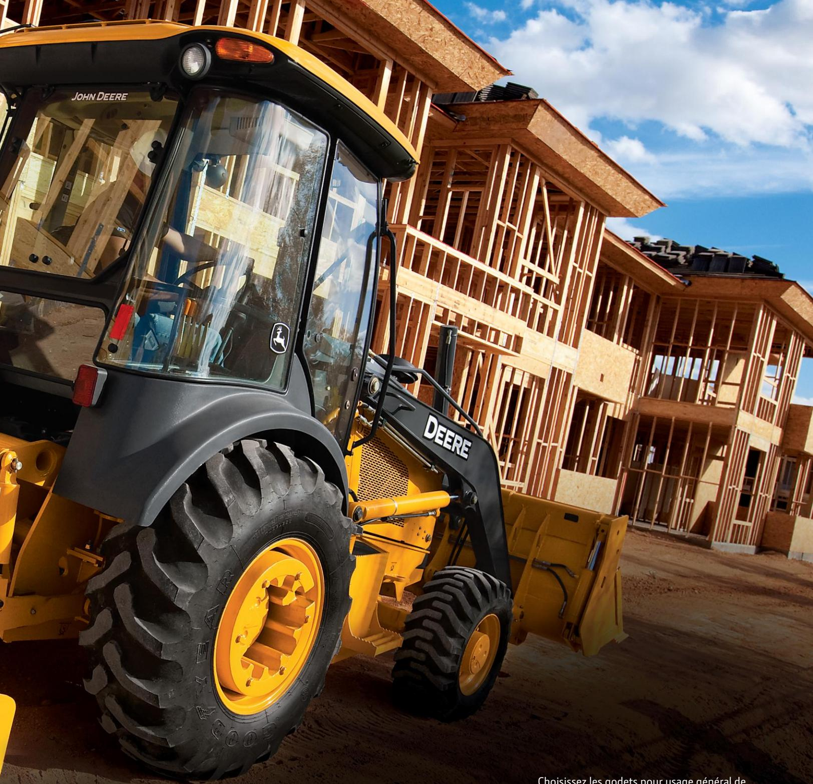
Fournissant autant de puissance de traction que le modèle 210LJ qu'il remplace, le tracteur chargeuse 210K EP peut vous suffire amplement. Il respecte les normes de Niveau 4 provisoire EPA / Phase IIIB UE sans composants de post-traitement ni filtre à particules diesel (DPF), ce qui en fait un excellent choix pour les grands parcs de machines et les entreprises de location.
