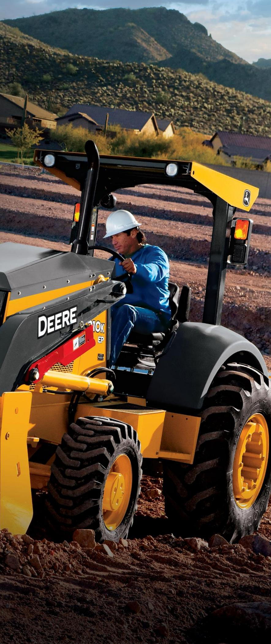
Le robuste châssis principal tout d'une pièce absorbe les charges de choc et résiste aux efforts de torsion. Il simplifie aussi l'accès pour le service des composants.
