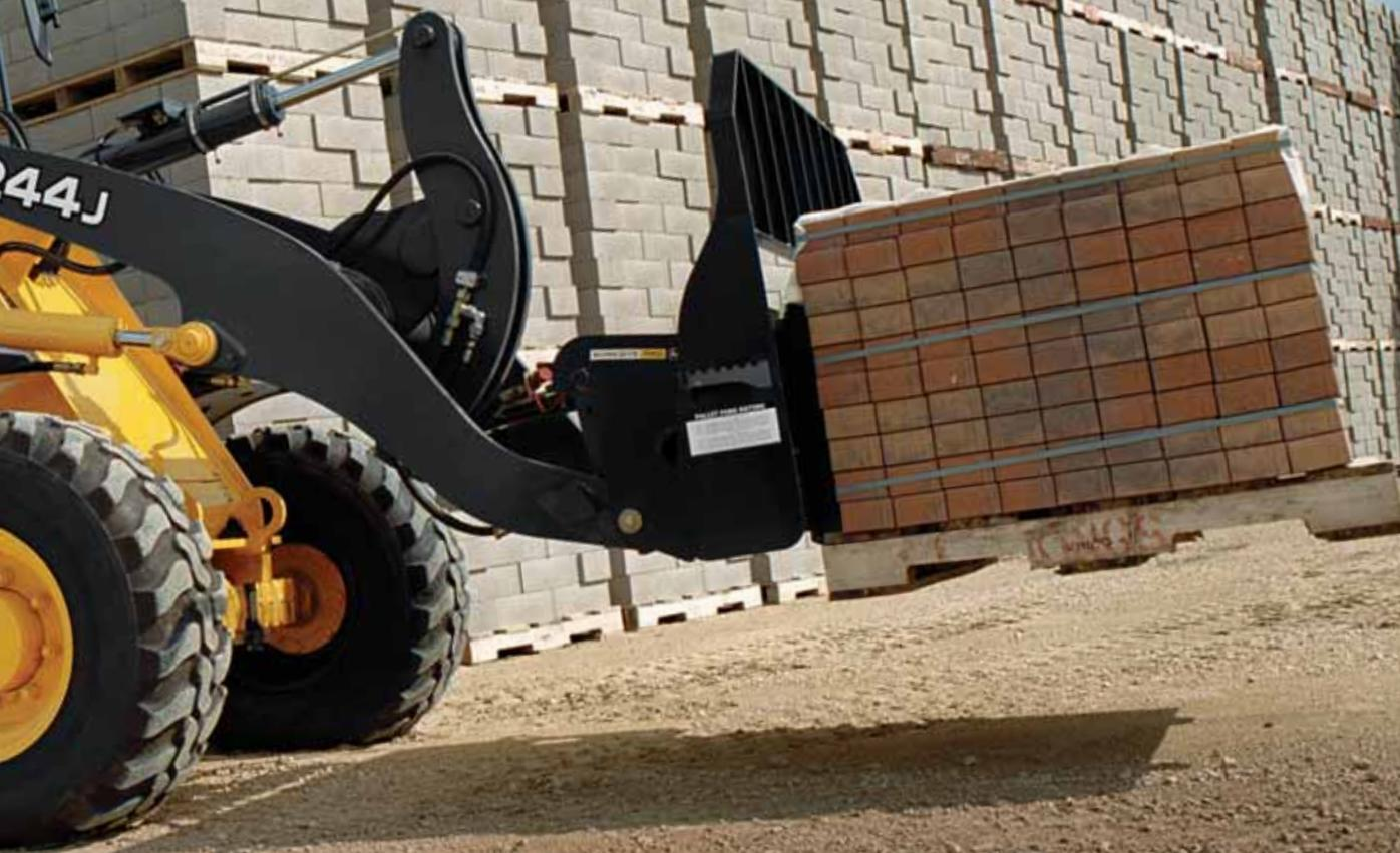
Il est souvent difficile de contourner les difficultés sur un chantier affairé. Contrairement à celles qui doivent virer en trois points (ou pire), la 244J à direction oscillante stéréo a un rayon de braquage d'à peine 376 cm pour une manoeuvrabilité inégalée. Et aussi, la capacité de charge de basculement est plus élevée.
