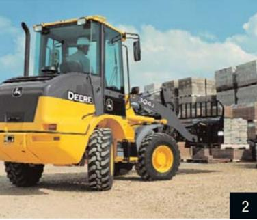
2. La configuration unique de la 304J lui permet de virer serré avec moins d'articulation, gardant le centre de gravité et l'alourdissement en ligne avec les forces de charge de réaction pour une capacité optimale de charge de basculement en virage.
