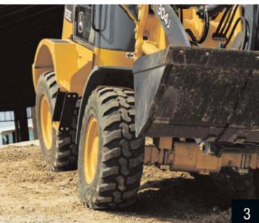
3. L'essieu arrière oscillant et l'articulation élastique du pivot adoucissent le roulement pour une meilleure rétention de la charge et un plus grand confort de l'opérateur.
