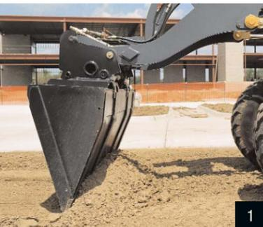
1. La flottaison de la flèche permet d'effectuer facilement le nettoyage et le nivellement en marche arrière.
