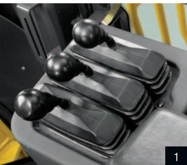
1. Les commandes pilotes sont faciles à utiliser et incorporent la caractéristique novatrice Quick-Shift de John Deere permettant de changer les vitesses du bout du doigt.
