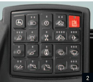
2. Le module d'interrupteurs scellé et rétroéclairé permet de contrôler facilement diverses fonctions. De plus, la hauteur maximale et le retour en position de transport ou de creusage peuvent être réglés tout en restant bien assis.
