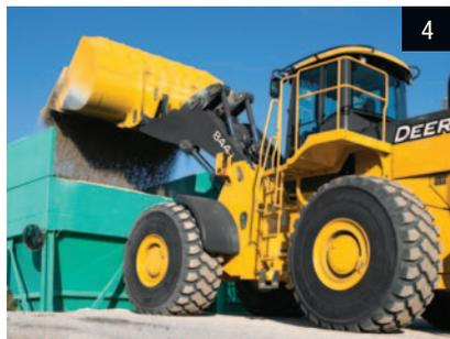
4. Le limiteur de flèche règle la hauteur maximale pour le déversement, et le retour en position de creusage ou de transport prédétermine la position basse de la flèche et du godet. Cela facilite les travaux répétitifs et aide à accélérer la production.
