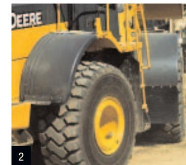
2. Les garde-boue et les bavettes aident à protéger la machine contre la boue et les débris.
