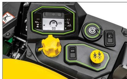
**Écran d'affichage** : grand écran ACL permettant de surveiller le niveau de charge de la batterie et trois modes d'utilisation pour modifier les réglages selon les préférences de l'opérateur et les conditions du terrain.
