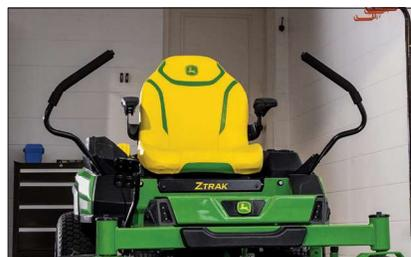
**Commandes intuitives** : le frein de stationnement intégré s'engage lorsque les leviers de commande sont poussés vers l'extérieur. Le bouton d'activation fait facilement démarrer la machine.
