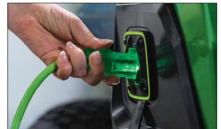
**Système de recharge intégré** : il n'y a qu'à brancher une rallonge électrique standard après les travaux de tonte. La technologie de recharge intelligente prévient la surcharge et prolonge la durée d'utilisation de la batterie.
